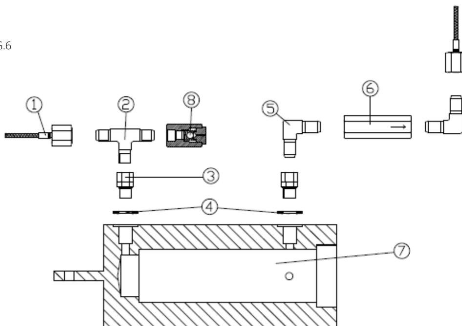
Componenti che possono essere installati sulle valvole DIREZIONALI: 1 tubo flessibile, 2 TEE, 3 nipplo, 4 guarnizione, 5 gomiti, 6 valvola di non ritorno, 7 pistone, 8 valvola di sfiato.
