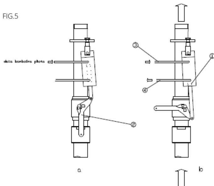
Il gas viene convogliato, mediante un tubo flessibile, dalla bombola pilota di azoto al pistone nel raccordo di ingresso.
